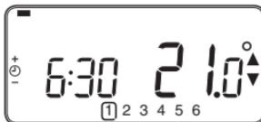
**Hinweis:** Das aktive Programm (PROG1 oder PROG2) wird in der oberen rechten Ecke der LCD-Anzeige dargestellt. Wählen Sie mit der **1/2** Taste das Programm, das Sie ändern möchten.
