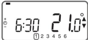
**NB:** rechtsboven in het LCD-scherm wordt het actieve programma (**PROG1** of **PROG2**) weergegeven. Selecteer met behulp van de **1/2**-toets het programma dat u wilt wijzigen.
